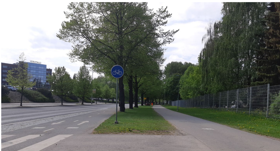
Kuva 2 Välikaista tarjoaa hyvän erottelun. Katuelementtejä hyödyntäessä tulee huomioida mahdolliset näkemäesteet, joita voi muodostua pyörätien viereen.
