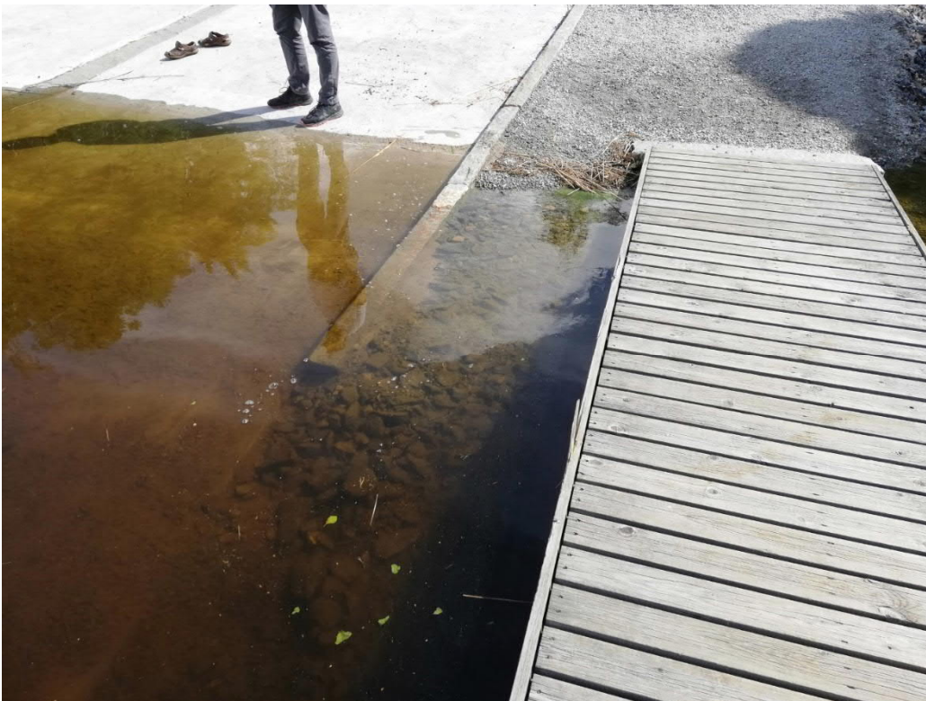
Kuva 7 Vedenkorkeus tarkastushetkellä 2.7.2019 oli n. +96,8 m. Tämä on n. 20 cm korkeammalla kuin vesistön pitkän ajan keskiveden keskiarvo MW(1981-2010) = +95,61 m.
