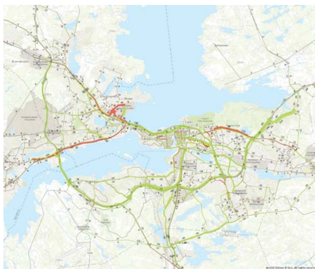
Kartta 3. Raitiotien ja sen maankäytön aiheuttama liikennemäärien muutos vuonna 2040 iltahuipputunnin aikana verrattuna bussivaihtoehtoon (vihreä on vähennystä ja punainen lisääystä).
