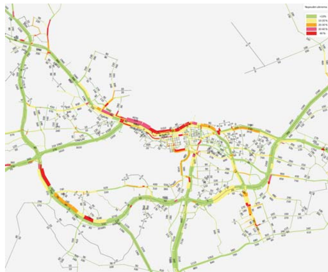
Kartta 2. Ajoneuvojen nopeuden alenema vuoden 2040 iltaruuhkassa verrattuna hiljaisen ajan liikenteeseen (mitä punaisempi sitä hitaammin liikkuva liikenne).
